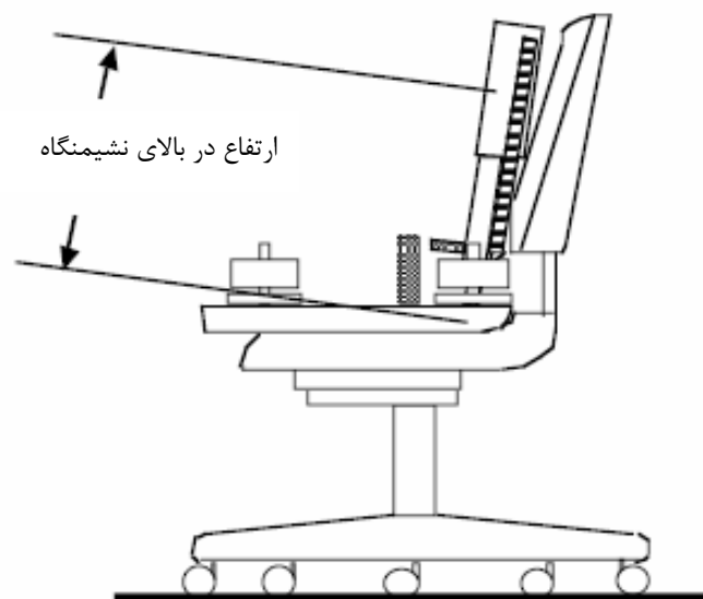
شکل ۴ - تعیین ارتفاع در آزمون استاتیک استحکام پشتی برای صندلی نوع ۱
