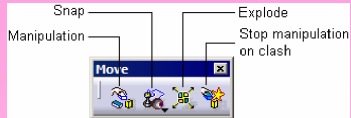
The Move toolbar نوار ابزار جابجایی
