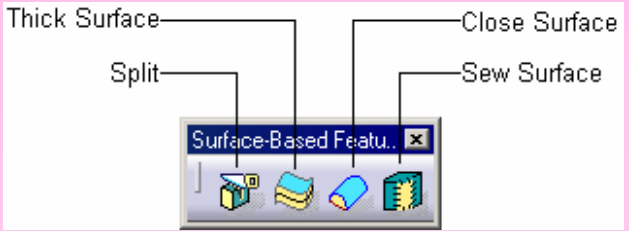
The Surface-Based Features toolbar نوار ابزار تعریف سطح
