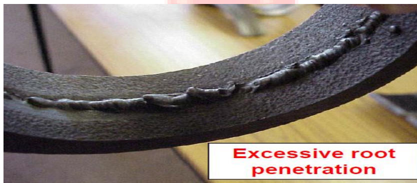
عیب رسوب بیش از حد ( سر رفتن مذاب ) در جوش
