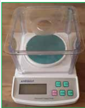
نام دستگاه: ترازو دیجیتال ۱۰۰ کیلوگرم با دقت ۱ گرم کارگاه: خاک و بتن
