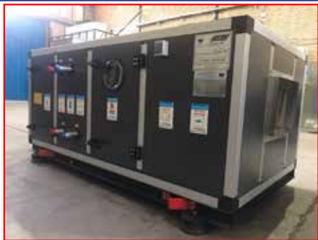
نام دستگاه: پیلا و هواساز کارگاه: تأسیسات
