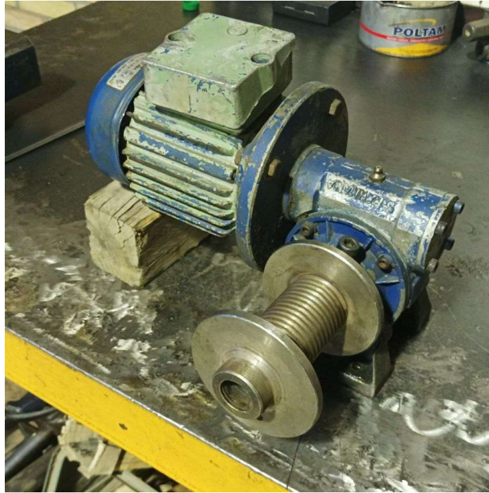
(شکل ۶-۹) فیکس کردن قرقره با استفاده از پیچ ضامن
